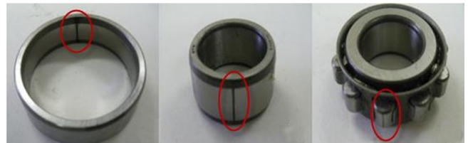
(a) 内圈故障 (b) 外圈故障 (c) 滚动体故障
